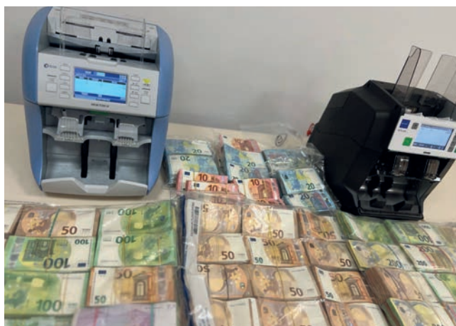
» Des appareils tels que le Glory GFS-220 (à droite sur la photo) permettent de compter, de trier et d'authentifier les billets de banque en un clin d'œil, mais aussi d'enregistrer leurs numéros d'identification.
